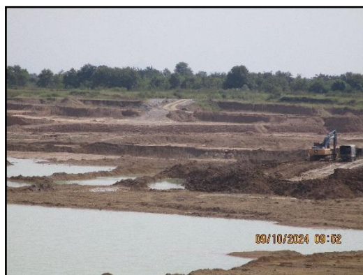
ภาพที่ 2.19 การเปิดหน้าเหมืองในลักษณะขั้นบันได
